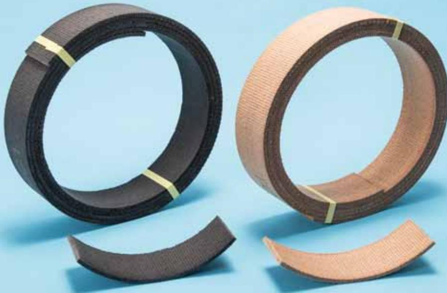
ウルトラストップ®ウーブン系摩擦材は、金属線入り耐熱性繊維で製織した生地に特殊合成樹脂結合材を含浸・加熱重合させたベルト状の摩擦材です。
