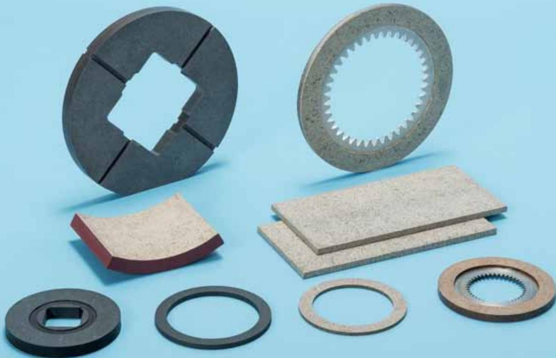
ウルトラストップ®モールド系摩擦材はアラミド繊維を主材とし、用途に応じて特殊熱硬化性樹脂、充填材、金属線などを加え、加圧・加熱成型した硬質摩擦材です。
